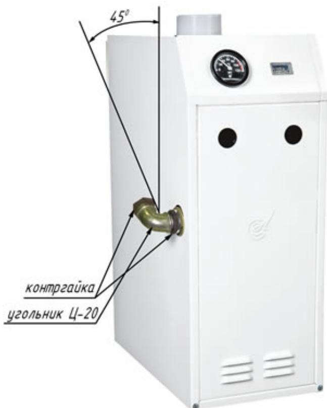
Соединения котла с системой отопления и газовой магистралью должны быть резьбовыми, позволяющими отсоединять котел. Расширительный бачок устанавливается в верхней точке главного стояка, желательно в отапливаемом помещении. При установке бачка в неотапливаемом помещении трубопроводы, бачок и сливную трубу необходимо тщательно утеплить.
